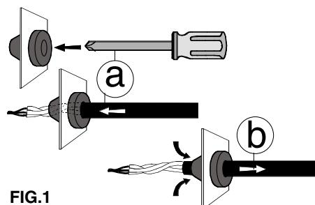
**I** Forare la membrana con il cavo o con un cacciavite e spingere il cavo o il tubo nel foro (a). Tirare leggermente indietro il cavo e il tubo per fissarlo (b).
